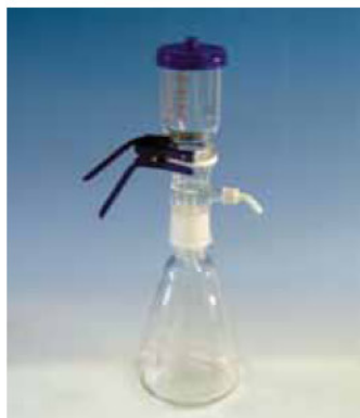
Zdj. 6. Zestaw filtracyjny GV050/2 i membrany RC55.
