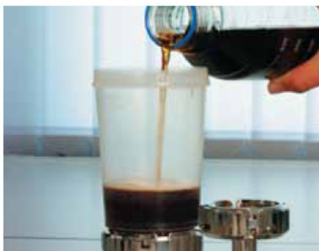
(B). Możliwość wyboru. Pojemność - 100 ml lub 350 ml Obudowa - ABS lub PP Wersja PP może być autoklawowana do 50 razy.
