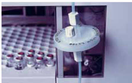
Zdj. 7. Filtr IFD z odgazowywaczem 50 mm.
